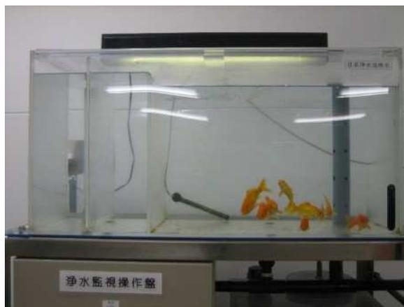
図4 金魚を用いた毒物検知装置
