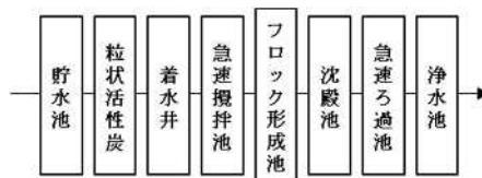
図2 千苺浄水場プロセスフロー
