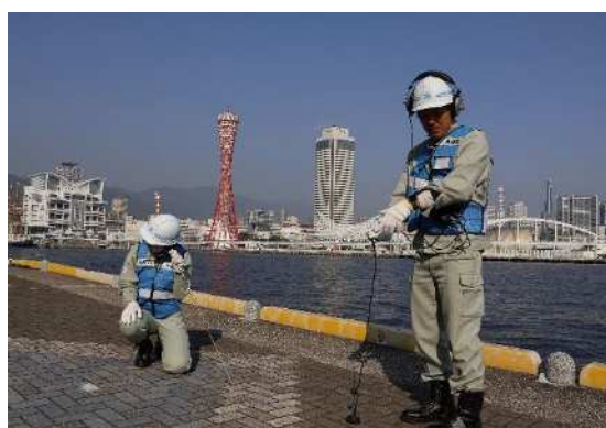
漏水調査の様子
